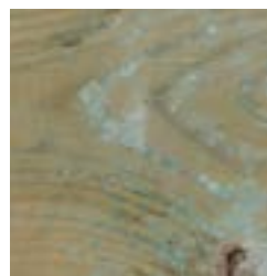
Retention of sterilization products Retención de productos de esterilización Rétention de produits détuve Rückstände von Sterilisationsprodukten Ritenzione di prodotti per la sterilizzazione Vasthouden van impregniatiemiddelen Retenção de produtos de esterilização
